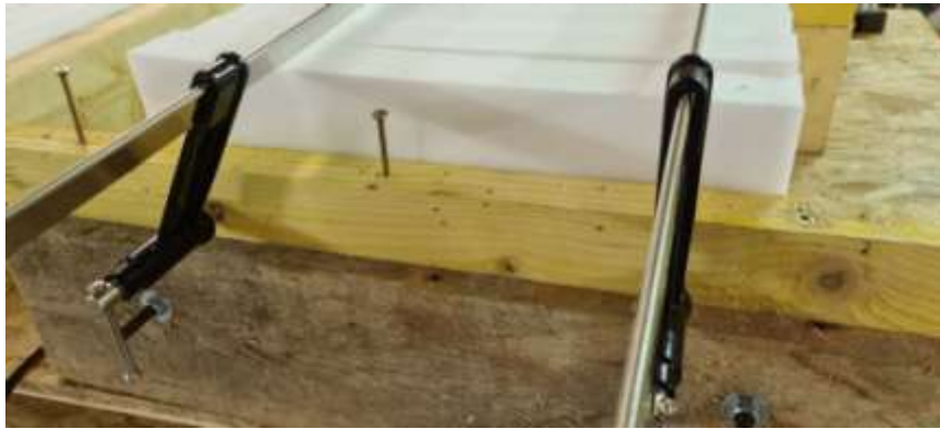
Figure 3 - Pré-serrage des mousses avec des serre-joints
